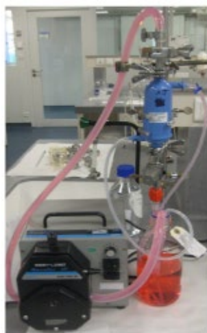
図 5-2 化学的適合性試験の装置例 ( 資料提供：メルク株式会社 )
