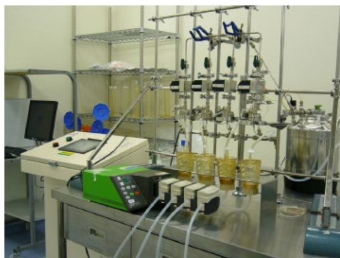
図 5-4 バクテリアチャレンジ試験の装置例 (資料提供：メルク株式会社)
