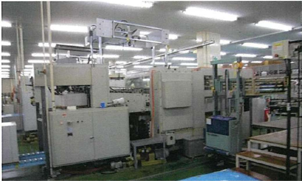
図 7-4 打抜き機
